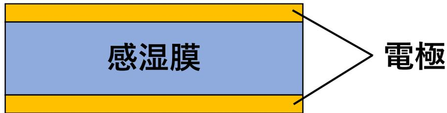
感湿膜が湿度に応じて吸湿し、誘電率が上昇することで湿度を計測
