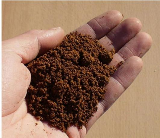
水道水に関東ローム土を分散して調製した**模擬泥水(比重:1.20)**
