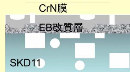
PVDコーティングの下地処理として金型鋼基材へ電子ビームを照射することにより、耐食性が向上
