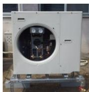
直膨方式GSHP実験機 10kW出力
