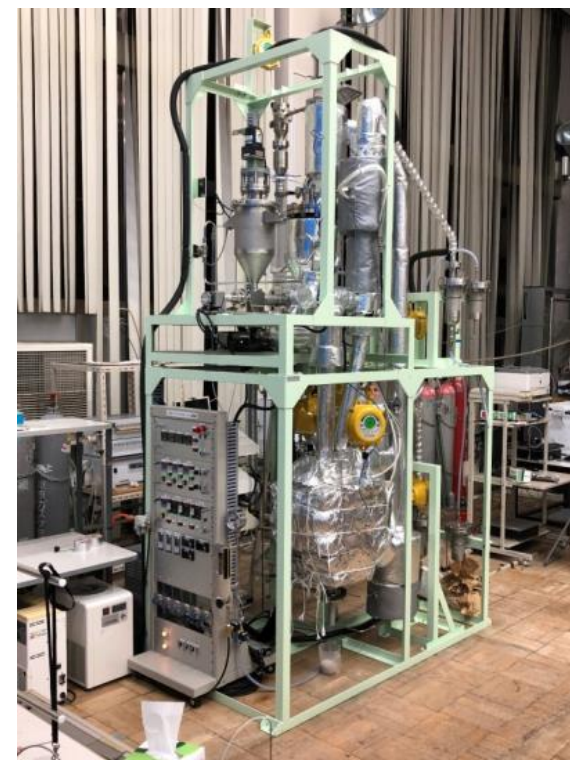
バイオマスガス化 パイロットプラント (2012-18年度 青森市委託事業により完成)
