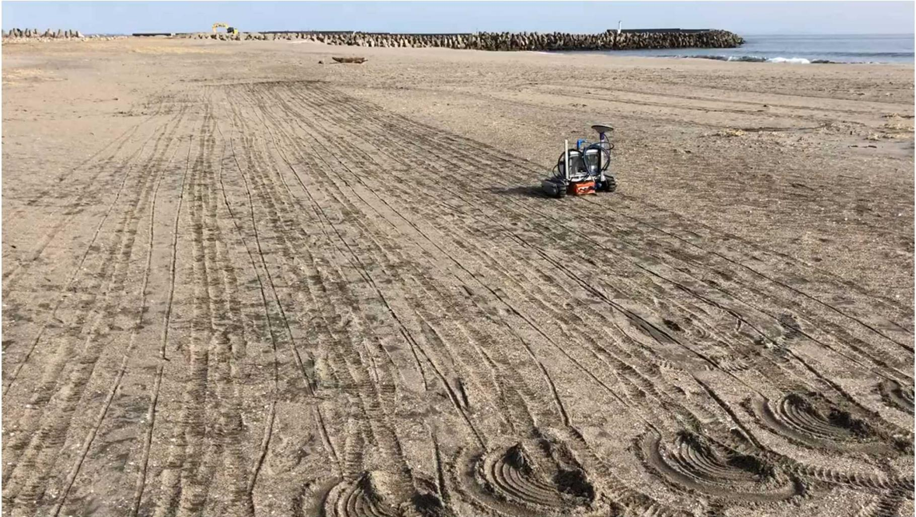
複数測線による3次元調査の実証実験
