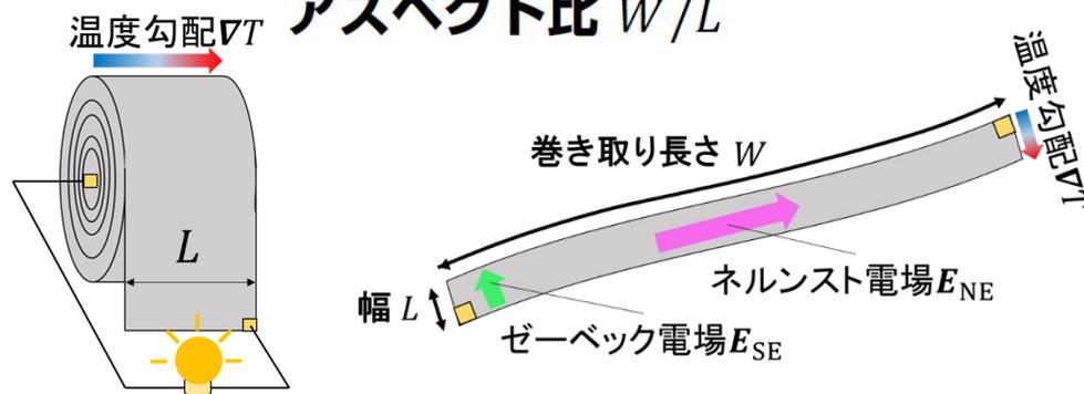
素子の電極配置を点接触とし、アスペクト比を上げることでネルンスト電圧が増強
