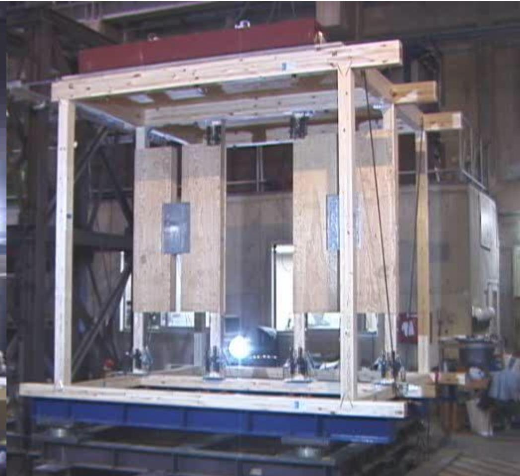
粘弾性ダンパー制振架構
