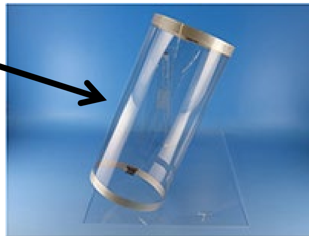
産総研のプラズマCVDで 成膜したグラフェン透明 ヒータ(ガラス基材)
