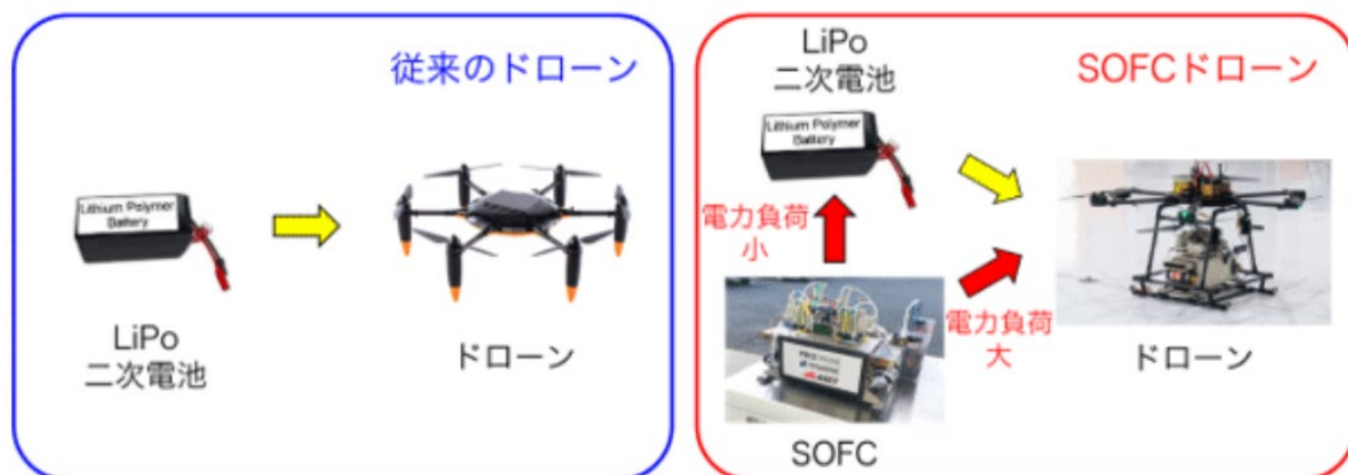
図4 従来のドローンとSOFCドローンの電力供給の模式図
