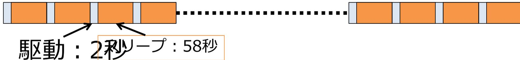
15分間隔保存回路使用 :  $(3.2 \text{ mA} \times 2 \text{ s} + 2 \text{ μA} \times 898 \text{ s}) \times 5 \text{ V} \times 4 \text{ 回}$
