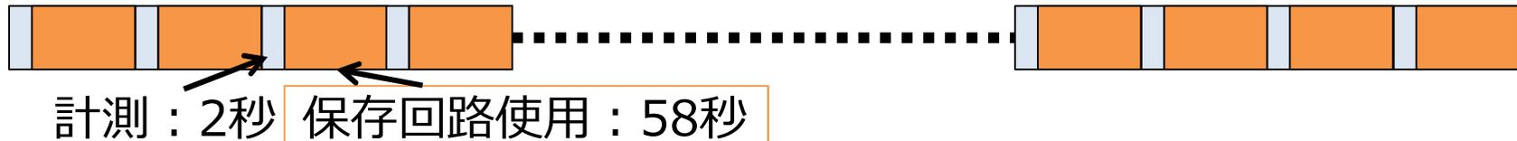
$$\text{15分間隔保存回路使用: } (3.2 \text{ mA} \times 2 \text{ s} + 3.1 \text{ mA} \times 898 \text{ s}) \times 5 \text{ V} \times 4 \text{ 回} = 55.8 \text{ W/h}$$
