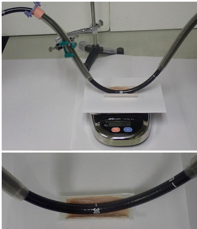
様々な濃度のヒドロキシルセルロース(HEC)で作成した潤滑剤を用いて、腸管屈曲部での大腸内視鏡挿入時に内視鏡シャフトが大腸粘膜に与える荷重を測定した。
