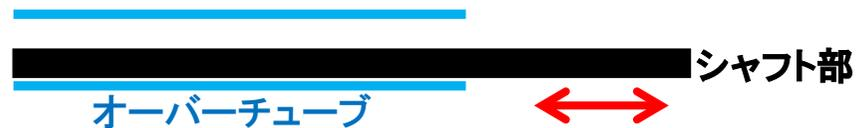
シャフト部を反復運動させて、オーバーチューブと内視鏡シャフト部の摩擦係数を経時的に測定する。時間経過と反復回数は対応。
