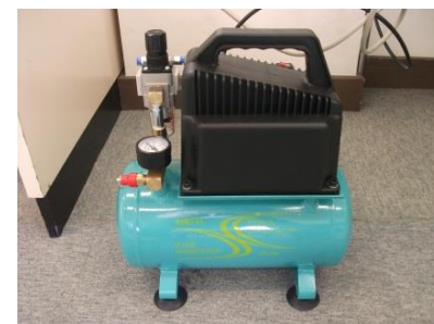
外部機器の例 (コンプレッサ)
