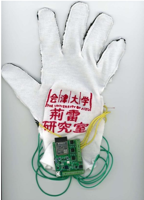
触覚手袋 (手指に46個の圧 力センサ)
