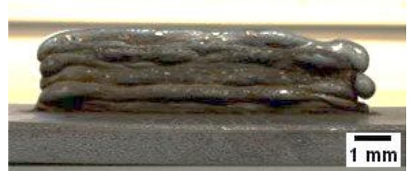
高精細な造形物を作製するためには、さらなるパラメータの適正化が必要であるが、新技術により積層が可能であることも確認している。
