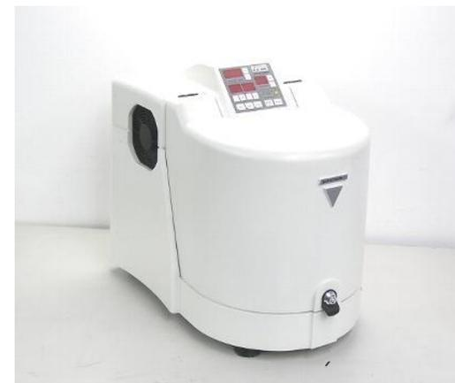
メカノラジカルによる新しい結合の形成と、高分子鎖の切断による分子量の低下が同時に起こる共重合体の合成に利用されている
